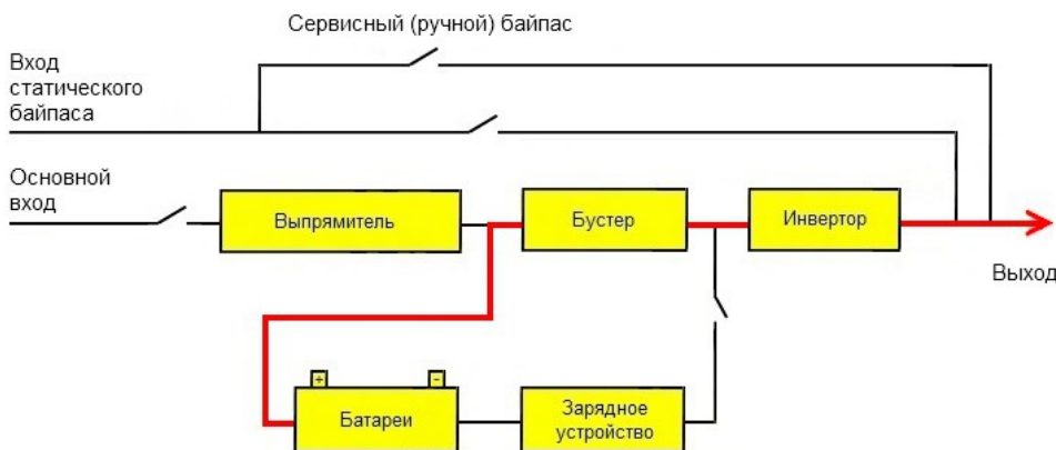
Схема работы в режиме от батарей.
