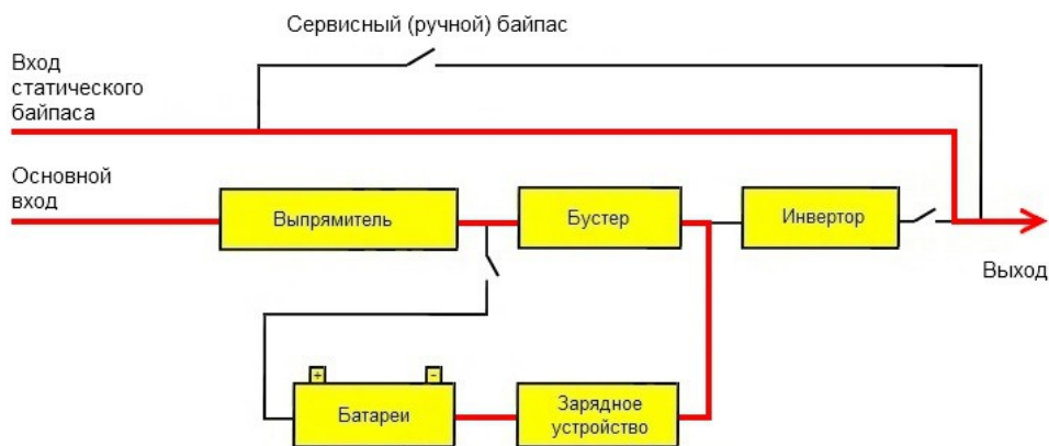
Схема работы в режиме статического байпаса
