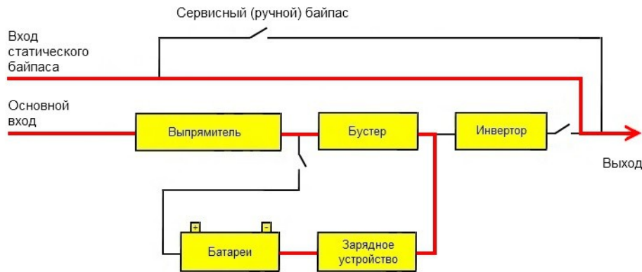
Схема работы в ЭКО режиме.
