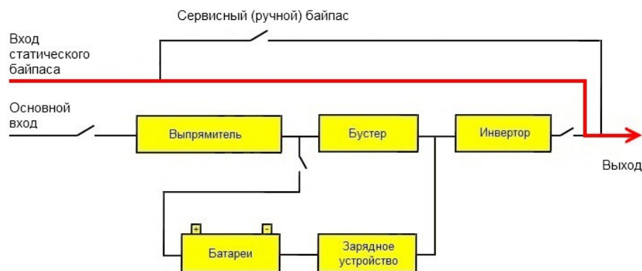
Схема работы в режиме неисправности.
