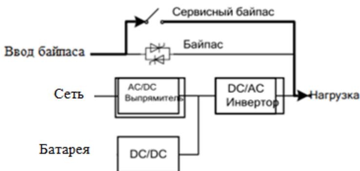
Рис. 2-6 Принцип работы режима сервисного байпаса
