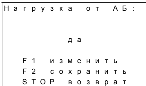
Рис.34. Запрет/разрешения питания нагрузки от АБ
