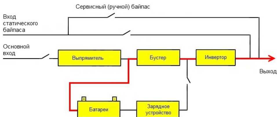
Схема работы в режиме от батарей.
